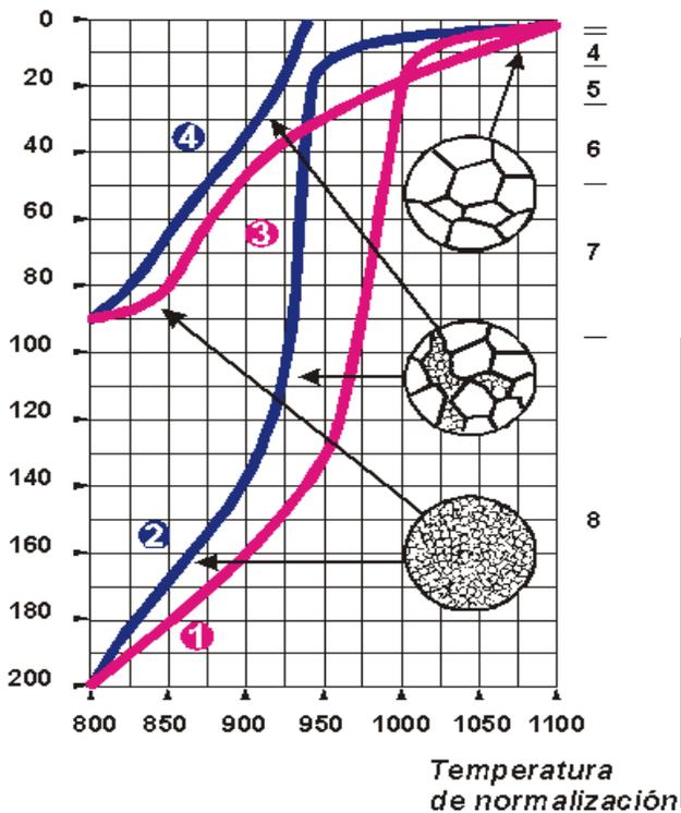
El comportamiento del tamaño del grano por efecto de la elevación de la temperatura es una variable a tener en cuenta y que se debe controlar; ya que al aparecer granos/cristales grandes por efecto del  $\Delta T$ , los aceros pueden llegar a perder propiedades de resistividad, elongación, templabilidad, compresión, tensión y a veces dureza.
